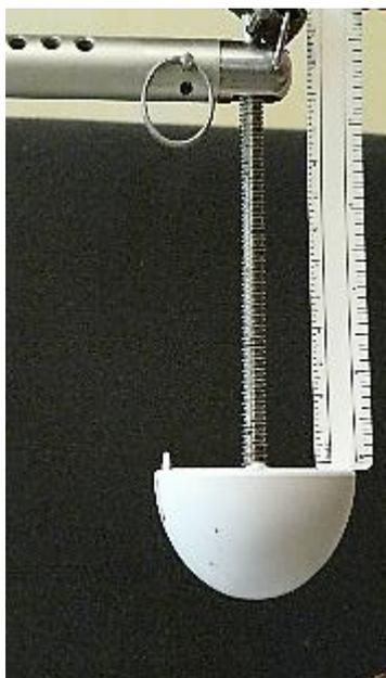
*Photographie 19 : Application du CRoC avec mesure du pas de vis*
